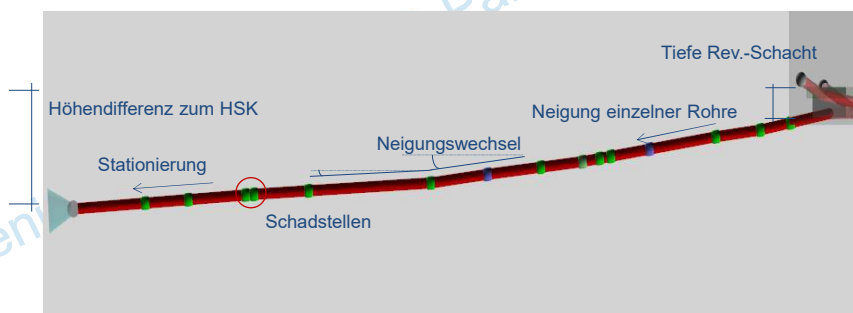
Darstellung des Leitungsverlaufs in 3D – Hausanschluss Schnitt
