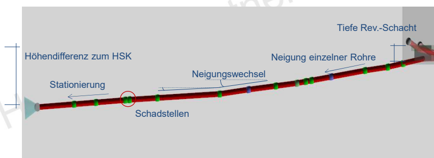
Darstellung des Leitungsverlaufs in 3D – Hausanschluss Schnitt
